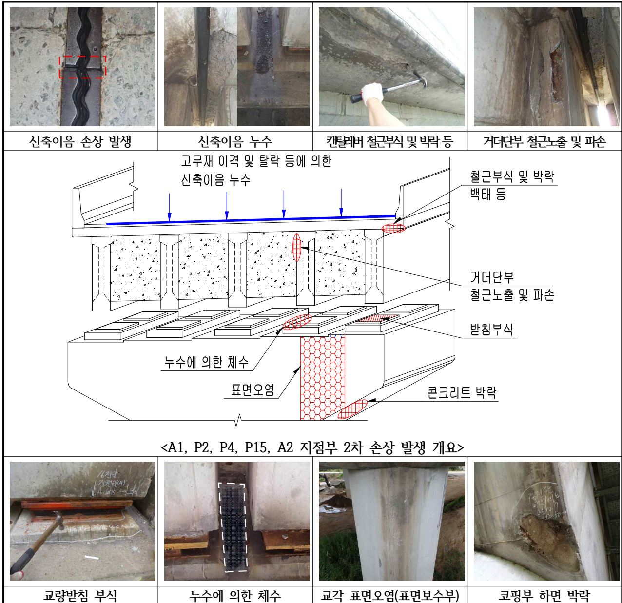
【그림 3.11】 신축이음 누수에 의한 손상 개요도
